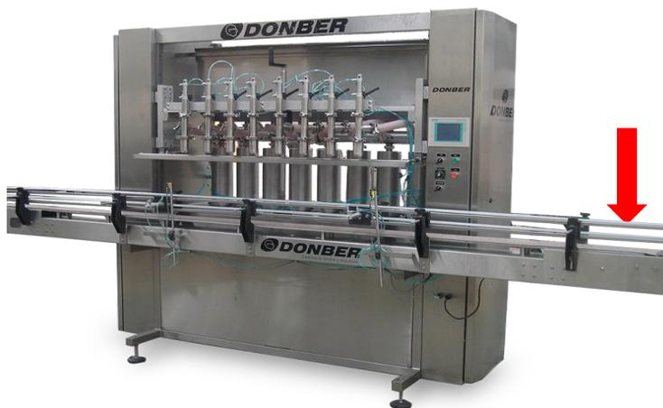
En la parte donde se encuentra la flecha se pretende colocar el cerrador para que el operario pueda colocar la tapa sin sostener el envase con una mano. Con el cerrador nuevo el operario podrá colocar y dar un pre-cerrado con ambas manos y agilizar el proceso.
